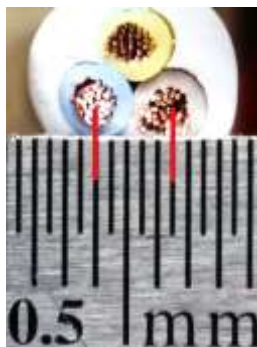
Pièce A.46 - Mesure de l'écartement des conducteurs d'une rallonge électrique standard
