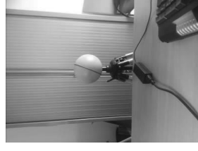
Figure 5-3: niveau de champ magnétique dans la bande de fréquences utilisée pour le CPL Linky Mesure sur un poste de travail, à 20 cm d'un bloc chargeur / alimentation d'ordinateur portable
