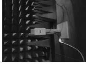
Figure 3-2 : compteur Linky et système de mesure de mesure du courant électrique
